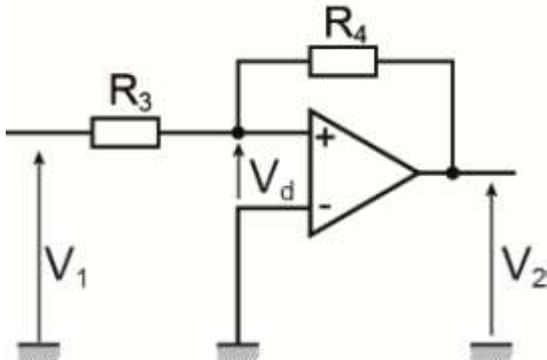
f- Les tensions seuils  $V_h = 0,5V$  et  $V_b = -0,5V$ . Tracer l'évolution de la tension  $V_2$  en fonction de  $V_1$  sachant que  $\pm V_{sat} = \pm 12V$ .
