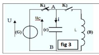
On appelle **q(t)** la charge del'armature reliée au point A et on précise qu'à l'instant t=0s cette armature est chargée positivement.
