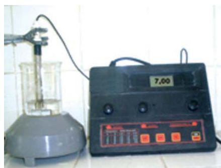
Figure 1 : Détermination du pH d'un mélange d'acide chlorhydrique et de soude.
