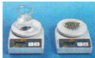
Figure 1 : Détermination de la masse de deux échantillons d'eau et de plomb à l'aide d'une balance électronique.
