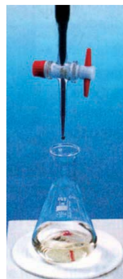
Figure 4. Décoloration de la solution de permanganate.
