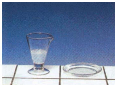
Figure 1b. Test à l'eau de chaux
